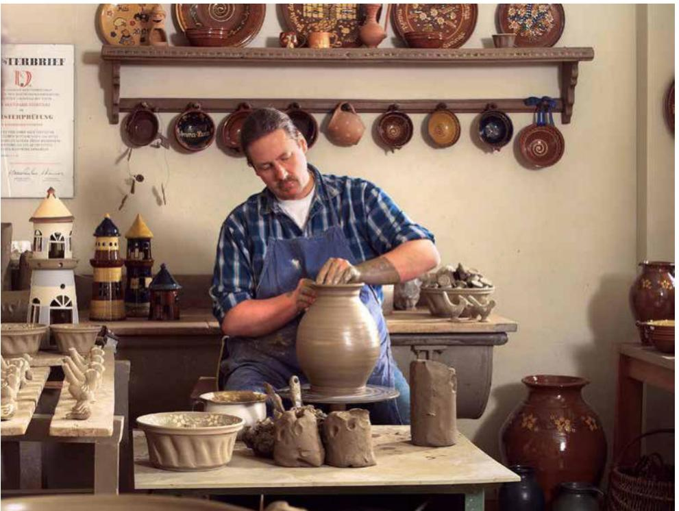
Abb. 17: Bernd Niehenke beim Drehen eines Gefäßes auf der Töpferscheibe. Die gedrehten Gefäße werden nach einer weiteren Bearbeitung abschließend im elektrischen Brennofen zweimal bei Temperaturen von 900 bzw. 1080 Grad Celsius gebrannt.
