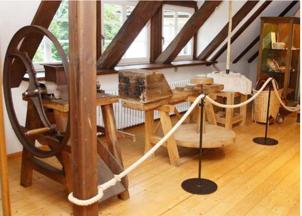
Abb. 27: Geräte des Töpfers im Töpfereimuseum im alten Pfarrhaus. Von links: Tonmühle, Drehbank und Töpferscheibe, Glasurmühle und Kiepe des Topfhändlers.
